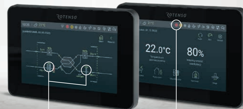
Wskazanie poziomu zabrudzenia filtrów
